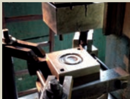
Prägwerkzeug zur Prägung des Deckels.
